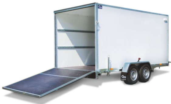
Auffahrklappe – leichte Handhabung, durch Gasdruckdämpfer unterstützt
