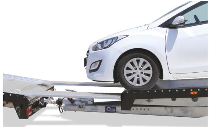
Überfahrampen auf das Zugfahrzeug aus Aluminium / pulverbeschichtete Ränder und Leuchtbalken in diversen Farben
